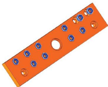
**Obs.:** Para todas as peças que forem fixadas na flange, deve-se utilizar parafusos M6 x 10 mm com arruela lisa 6 mm, caso contrário corre-se o risco de quebrar o vidro.
